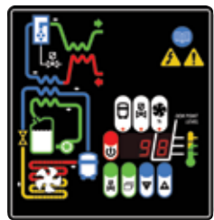
Displej sušičky Dec se procentuálními údaji o úsporách energie
